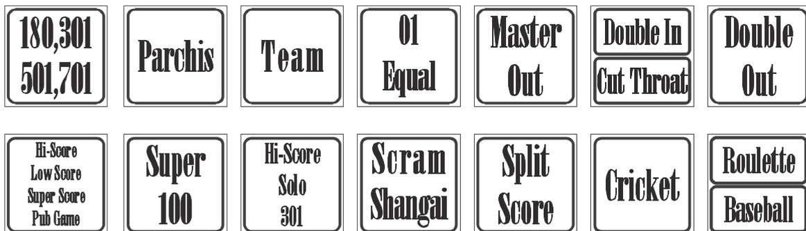
Abb. 4 zeigt die Tasten auf der Gerätetür. Wenn der Kredit aktiviert wird, beginnen die Spieltasten zu blinken. Die Tasten sind mit mehreren Funktionen belegt, die Spielauswahl wird auf dem Cricket Display angezeigt. Danach können die Optionen gewählt werden.
